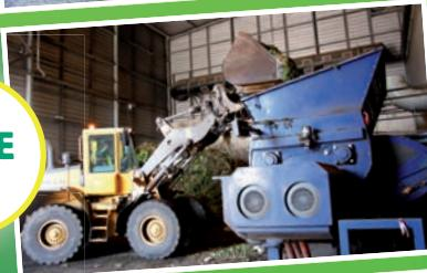
Les biodéchets sont mélangés avec des déchets végétaux broyés secs pour permettre leur transformation en compost. Ce mélange est ensuite déposé dans des tunnels.
